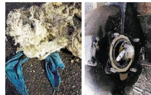
最近、マンホールポンプ場に異物が流入してポンプが停止する事故が多発しています。
